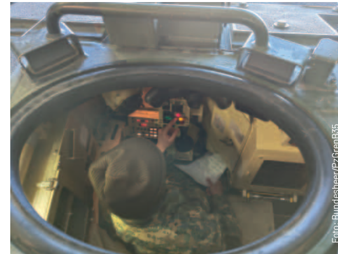
Blick auf den Platz des Panzerkommandanten, auch hier muss sich der Richtschütze gut auskennen und alle Geräte bedienen können. Gut erkennbar sind hier unter anderem das Waffenbediengerät, die Feuerleitanlage und der Kommandantenrichtgriff. Rechts sieht man die Abdeckungen für das Turm-Maschinengewehr und die Maschinenkanone.
